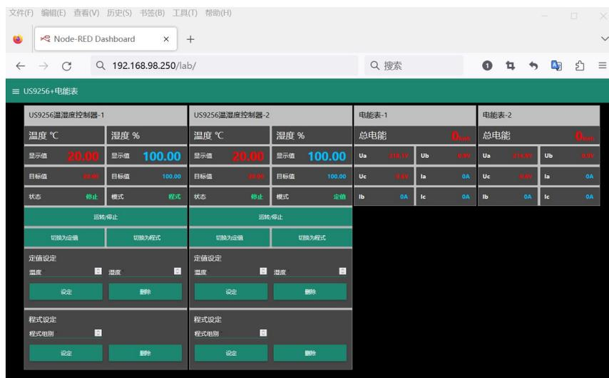
2. 画面中有 2 个温湿度控制器和 2 个电能表，连接产品数量可以任意扩展，基本型只有 1 个温湿度控制器+1 个电能表连接。
