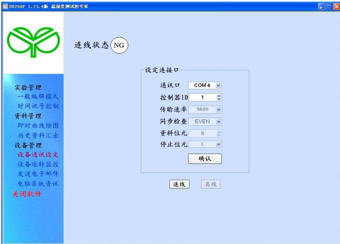
图 2 串口及控制器 ID 设定好后按下确认钮，“连线”按钮由灰暗变成显明可按之钮。
